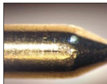
Han D® Kontakte mit GoldTec-Oberfläche nach 500 Steckzyklen
